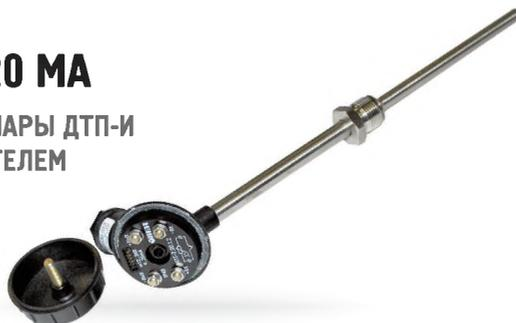
Термометры сопротивления и термопары ОВЕН выпускаются с встроенным нормирующим преобразователем с напряжением питания 24 В и выходным сигналом тока 4...20 мА. Датчики с выходным сигналом тока 4...20 мА изготавливаются только с одним чувствительным элементом, с 2-проводной схемой подключения и увеличенной пластмассовой коммутационной головкой. Все позиции данных датчиков изготавливаются на заказ (см. Обозначение при заказе).
