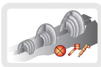
Паровые турбины. Контроль температуры пара и подшипников, контроль давления пара, выдача аварийных сигналов
