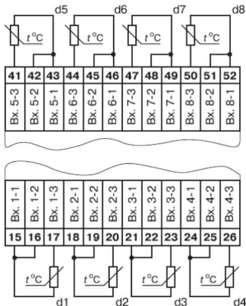
Рис. Б.8. Пример схемы подключения термопреобразователей сопротивления
