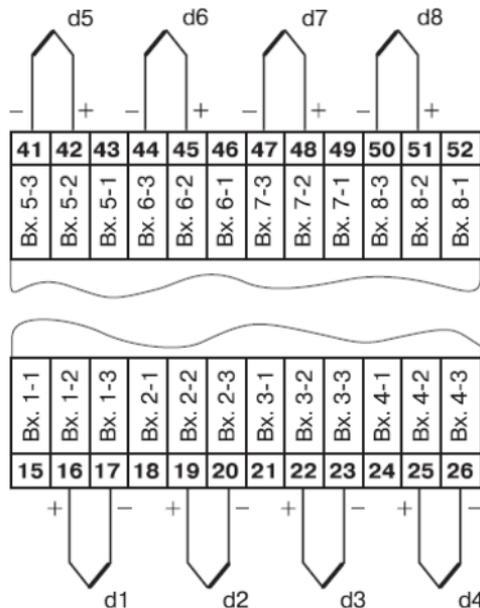
Рис. Б.9. Пример схемы подключения термопар
