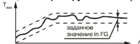
Рис. 3.6, в. Включен фильтр in.FG
