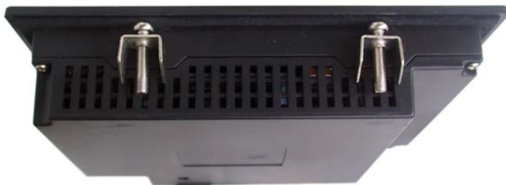
Рисунок 4.1 - Установка крепежных зажимов
