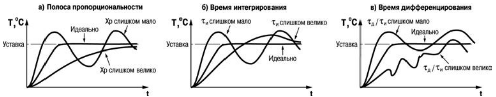
Рисунок Г.3 – Примеры графиков переходной функции
