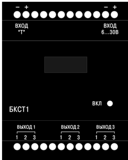
Рисунок А.2 - Внешний вид лицевой панели БКСТ1
