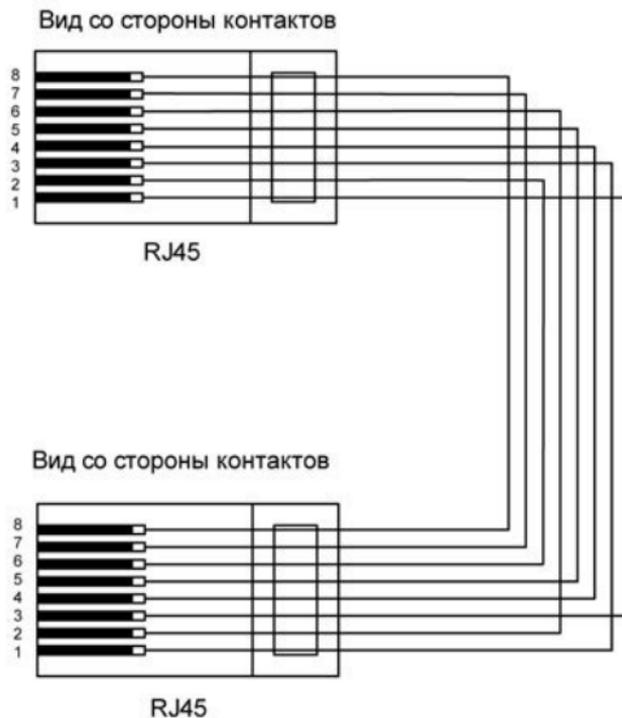
Рисунок Б.1 – Схема кабеля Ethernet Crossover
