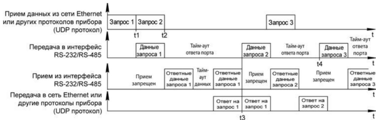
**Рисунок 4.6 – Диаграмма работы прибора в режиме «запрос – ответ»**
