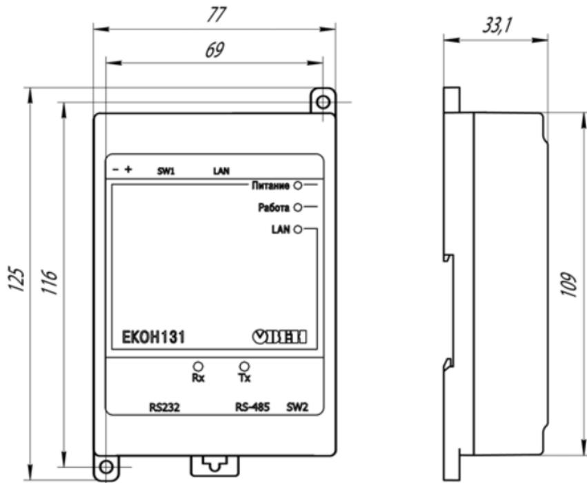
Рисунок А.1 – Габаритный чертеж
