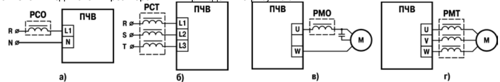
Рисунок 5.1 - Схемы подключения реакторов: а) серии PCO во входных цепях питания ПЧВ с однофазным входом; б) серии PCT во входных цепях питания ПЧВ с трехфазным входом; в) серии PMO в выходных цепях ПЧВ для питания однофазных электродвигателей; г) серии PMT в выходных цепях ПЧВ для питания трехфазных электродвигателей.
