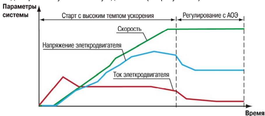
Рисунок 4.2 - Принцип работы оптимизации энергопотребления
